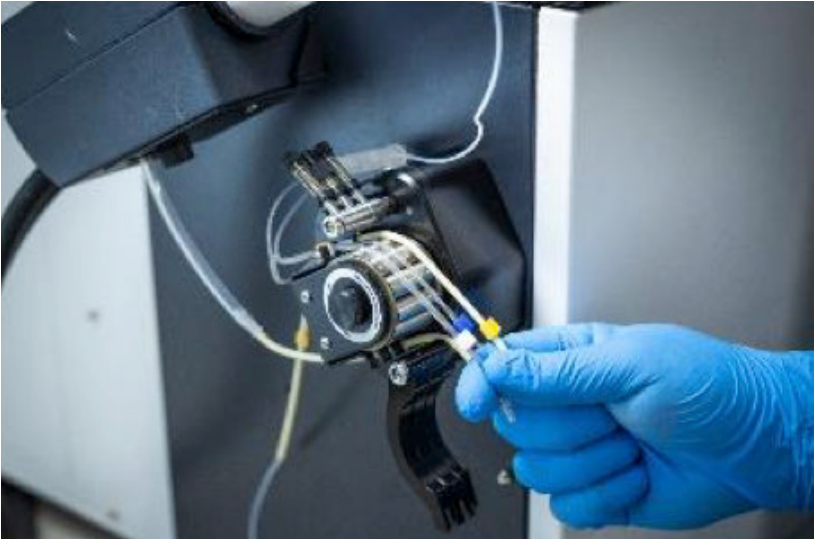
Abbildung 15: Der Pumpenschlauch muss mit dem verwendeten Lösemittel kompatibel sein.
