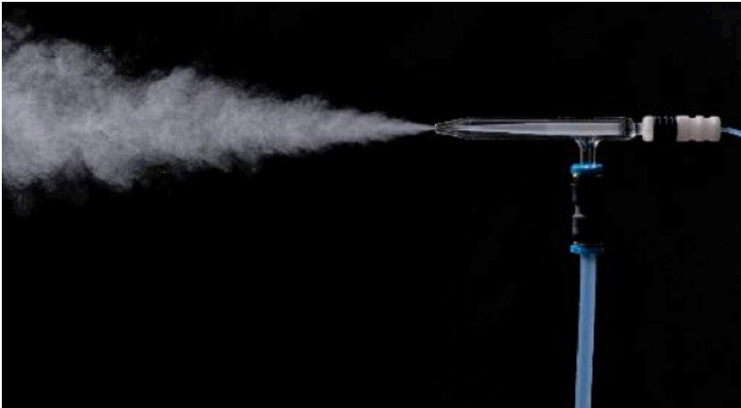
Abbildung 12: Proben werden üblicherweise in flüssiger Form der Messung mittels Elementspektroskopiemethode zugeführt. Alle Methoden, außer der GFAAS, verwenden einen Zerstäuber, um die flüssige Probe in ein Aerosol zu überführen. In der GFAAS wird die flüssige Probe mit Hilfe einer Spritze injiziert.
