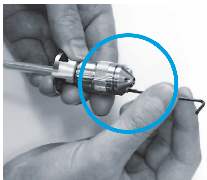
图 72. 拧松雾化器头
