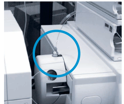
図 43. 取り付けが完了した CE/ESI-MS スプレーヤー
