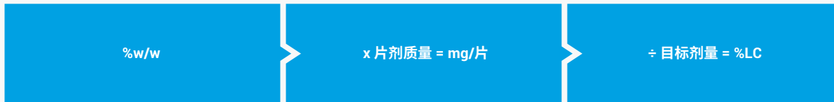
图 9. TRS 方法开发中的单位为 %w/w，当乘以片剂质量时得到剂量，当除以目标剂量时得到 % 标示量
