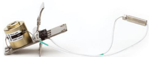
Celda de flujo bioinerte con etiqueta RFID, 10 mm, 13 µl (ref. G5615-60022)
