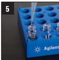
放入自动进样器样品瓶中 进行气相色谱或液相色谱分析
