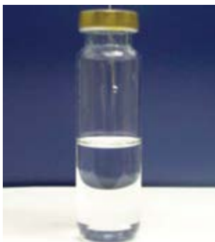
图 6.5 顶空单滴微萃取的配置
