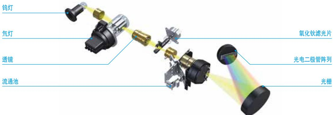
图 3.25 二极管阵列检测器的光学系统
