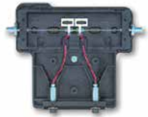
检测器 2，配备 3.7 mm 光程流通池
