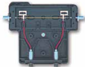
检测器 1，配备 60 mm 光程流通池
