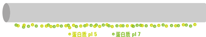
图 2.1 一种载体两性电解质和样品蛋白的混合物填充在分离毛细管中。灰色表示预混合。
