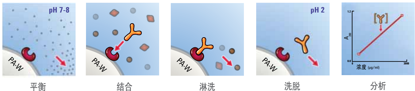
图 1. 配置 AssayMAP Protein A 纯化柱的安捷伦 Bravo 蛋白质纯化系统的完整捕集流程，结果用于蛋白质的滴度分析。Protein A 在中性 pH 下捕集单克隆抗体，然后使用酸性缓冲液在低 pH 下将单克隆抗体洗脱出来。生成的校正曲线用于准确测量生物反应器中产生的单克隆抗体的浓度
