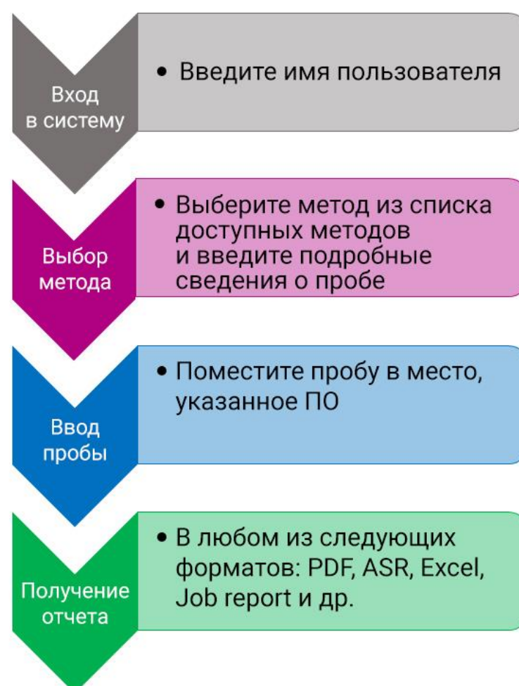
Рис. 2. Стандартный рабочий процесс пользователя системы ВЭЖХ-МСД iQ Agilent WalkUp.
