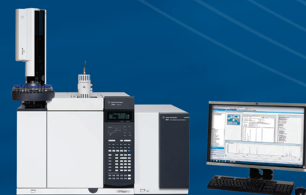
Agilent 8355 SCD 与 Agilent 7890B GC 和 OpenLAB 色谱数据处理系统软件全面集成，具有高选择性和高灵敏度，适用于复杂的痕量硫分析方法。
