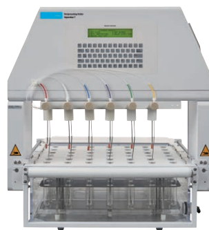
图 4. 安捷伦 50 mL 往复架 7 法溶出度仪，显示为 6 × 7 自动配置
