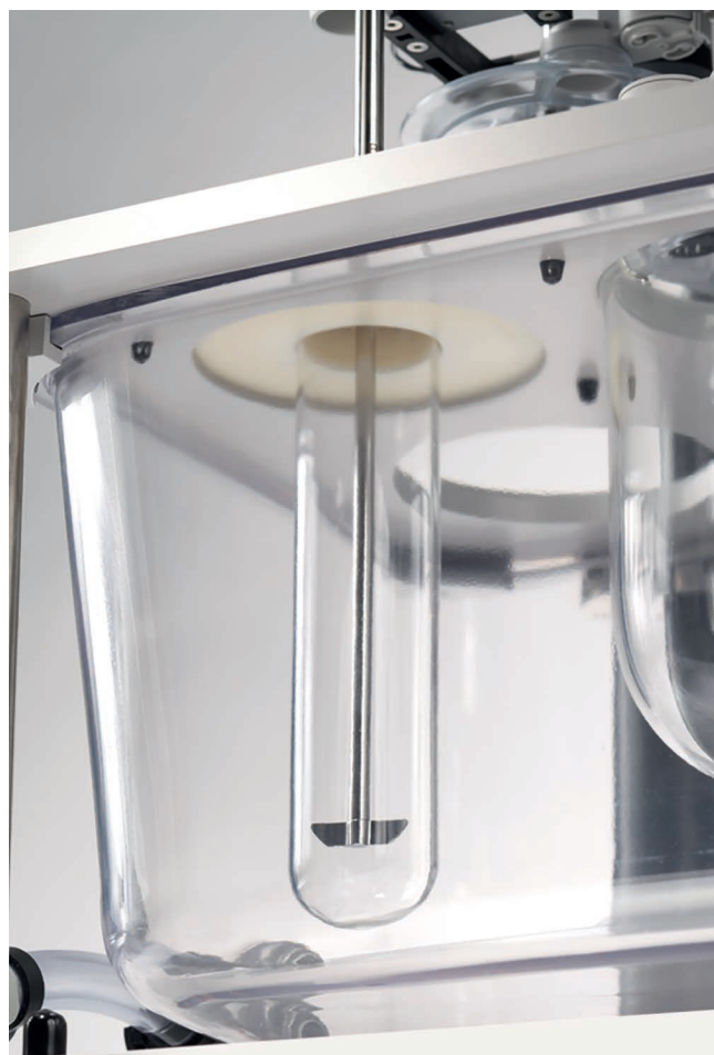
图 3. Agilent 708-DS 转换工具包（部件号 12-6368），200 mL 溶出杯
