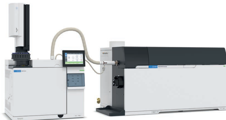
图 1. 使用安捷伦全面加热的 GC-ICP-MS 接口将 Agilent 8900 ICP-MS/MS 与 Agilent 8890 GC 联用
