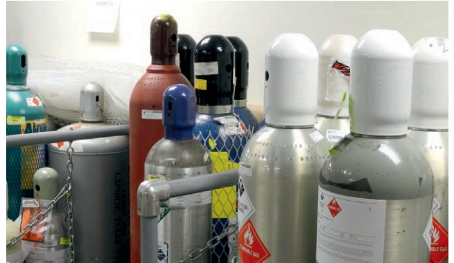
그림 1. 많은 반도체 가스는 독성, 인화성 또는 발화성이기 때문에 전문적인 GC 시료 도입이 필요합니다.
