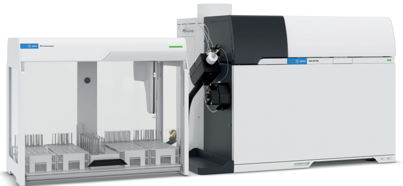
그림 1. Agilent SPS 4 자동 시료 주입기가 포함된 Agilent 7850 ICP-MS — 일반적인 시료 유형을 일상적으로 분석하기 위한 강력한 결합.
