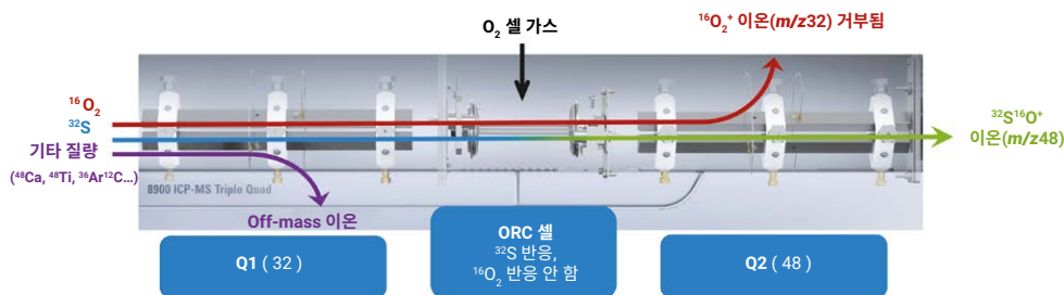
그림 1. O_2 셀 가스를 사용한 MS/MS mass-shift로 ^{32}S^+ 에서 ^{16}O_2^+ 중첩을 분리합니다. m/z 49 및 50에서 SO^+ 생성 이온으로 측정된 미량 동위원소 ^{33}S 및 ^{34}S .
