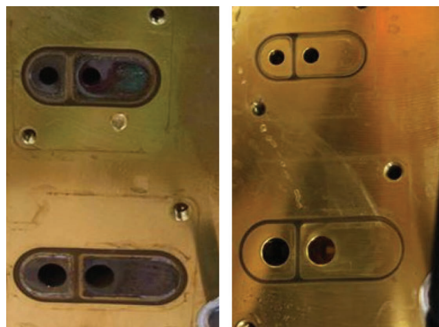
图 2. ICP-MS 冷却水歧管运行数月后，其中冷却回路使用了不同类型的流体。左图：使用未经批准的冷却液运行两个月后。右图：使用 Agilent Cool Clear 运行 3.5 个月后
