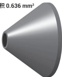
图 4. 左图：与镍截取锥配套使用的不锈钢截取锥基座。右图：与铂尖截取锥配套使用的黄铜截取锥基座
