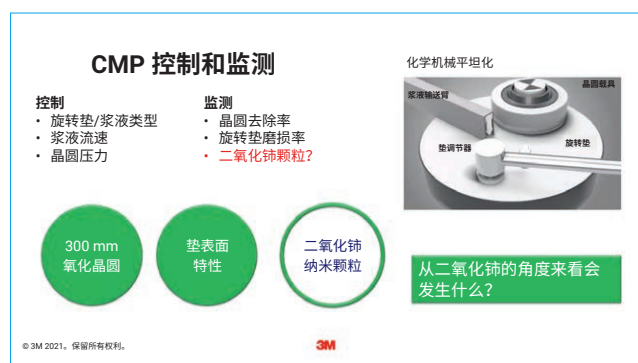
图 2. 研讨会幻灯片，显示了 CMP 过程中的关键变量。© 3M。经授权转载
