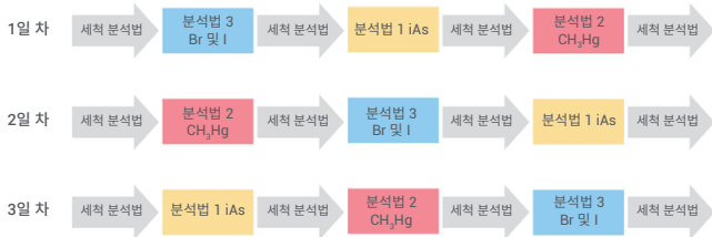
그림 3. 3일 동안 실행한 자동 다중 분석법 HPLC-ICP-MS 시퀀스에 대한 실험 순서도.
