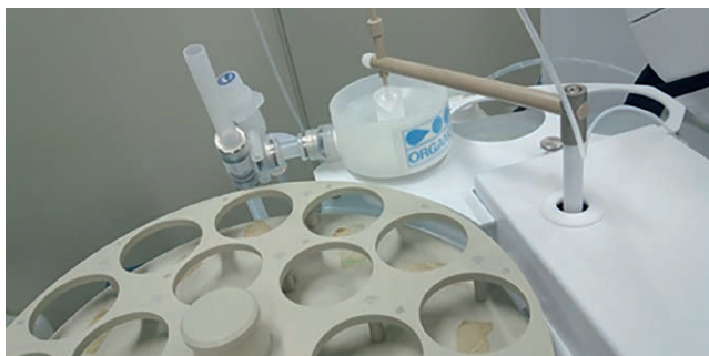
图 1. 配备 Organo UPW 流动清洗口系统的安捷伦 I-AS 自动进样器
