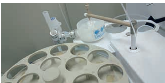
Рисунок 1. Автосамплер Agilent I-AS с установленным проточным промывочным портом сверхчистой воды Organo.
