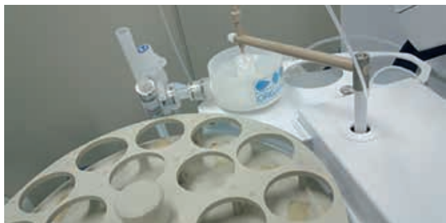
Figura 1. Amostrador automático Agilent I-AS com sistema de porta de enxágue UPW Organo.
