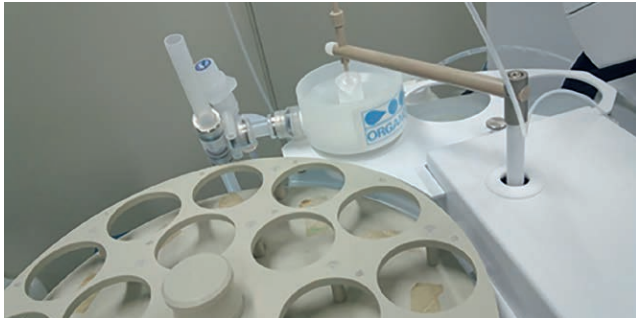
그림 1. Agilent I-AS 자동 시료 주입기와 Organo UPW 흐름 세척 포트 시스템
