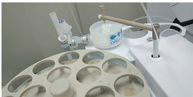
図 1. Agilent I-AS オートサンブラとオルガノの UPW フローリンスポートシステム。
