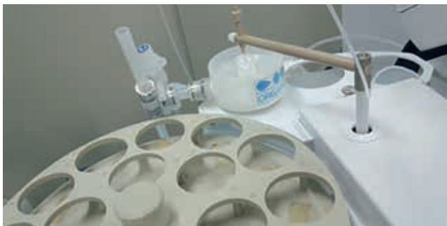
Figura 1. Autocampionatore I-AS Agilent con sistema di porta di lavaggio a flusso di UPW Organo.
