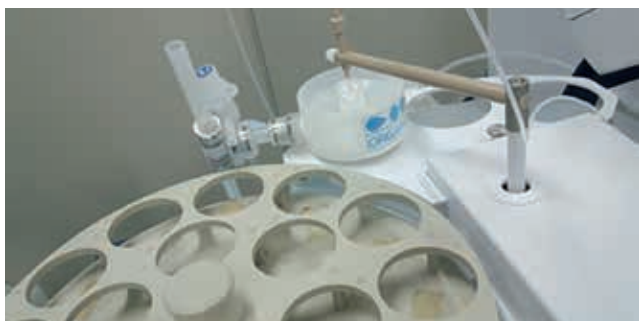
Figure 1. Passeur d'échantillon intégré I-AS Agilent avec système de circulation continue d'eau ultrapure conçu par Organo pour le port de rinçage.
