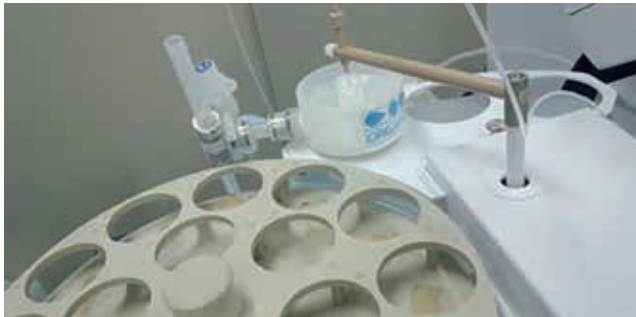
Abbildung 1. Der Agilent automatische integrierte Probengeber mit dem UPW-Spülanschlusssystem von Organo.
