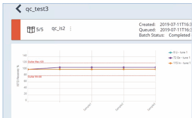
図 1. ISTD 回収率プロットと上限値および下限値が表示された ICP Go の画面
