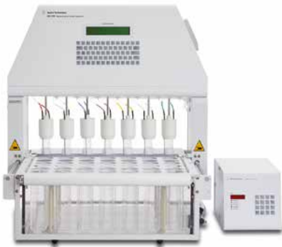
Aparato de cilindro alternativo Agilent BIO-DIS (Aparato 3 da USP)
