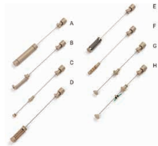
Figura 5: (A) Cesta em PEEK, com "Mesh" no fundo, (B) Suporte "bed flat", (C) Suporte para "Stent" (5mL), (D) Cesta em PEEK pronta, (E) Cesta com "Mesh", (F) Suporte para lentes de contato, (G) Suporte para "Stent" (10mL), (H) Suporte para marca-passo (chumbo)
