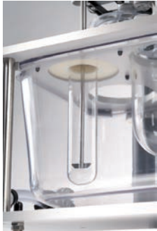
200 mL vessel and mini paddle
