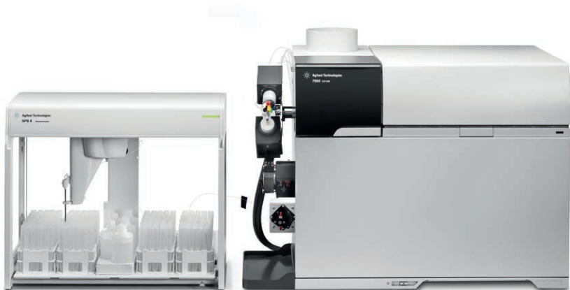
图 1. 配备可选的 ISIS 3 不连续进样 (DS) 附件并与 Agilent SPS 4 自动进样器联用的 Agilent 7900
