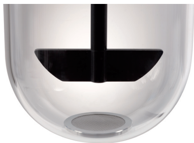
Figure 1: USP Apparatus 5 (paddle over disk)
