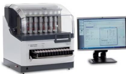
Agilent 400-DS Dissolution Apparatus 7
