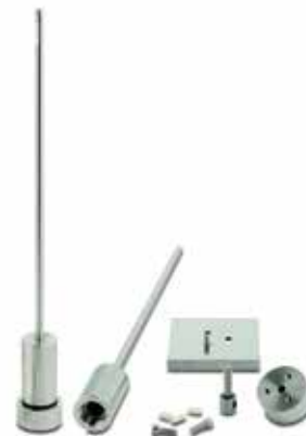
Figura 1. Componentes do disco giratório de dissolução intrínseca.
