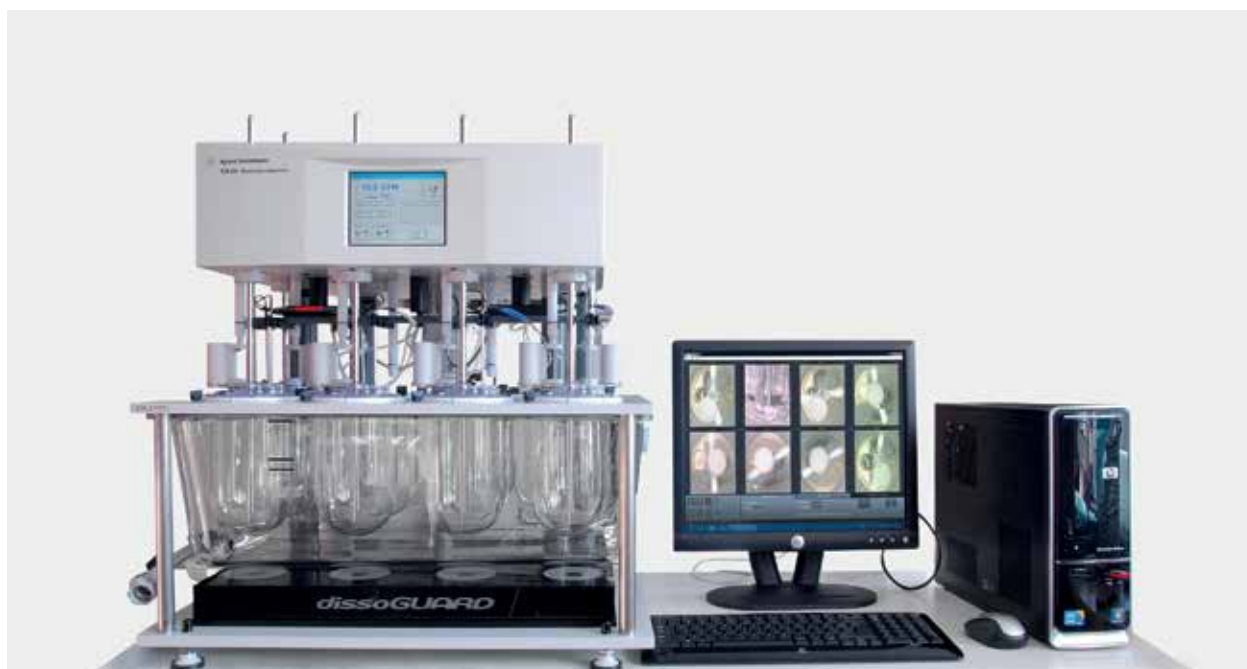
Figura 5. O dissoGUARD adapta-se de forma prática embaixo do 708-DS, oferecendo visualização de cada recipiente individual.
