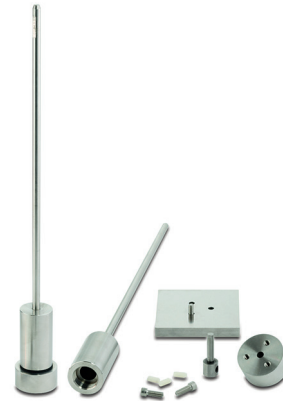
図 1. Intrinsic 法による溶出試験のための回転ディスクコンポーネント
