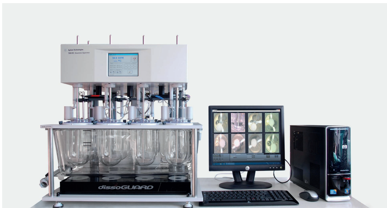
图 5. 将 dissoGUARD 方便地安装在 708-DS 下，可以看到每个溶出杯中的情形
