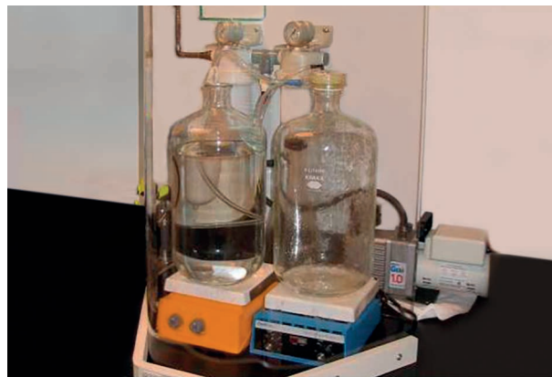
图 4. 根据 USP 搭建的典型实验室脱气装置
