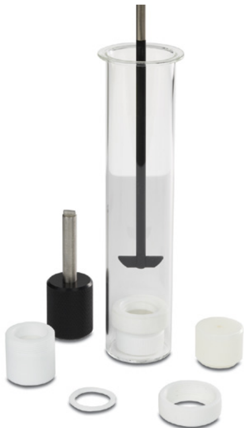
Рис. 1. Ячейка-выделитель Agilent сборной конструкции в трех размерах в зависимости от свободной площади поверхности
