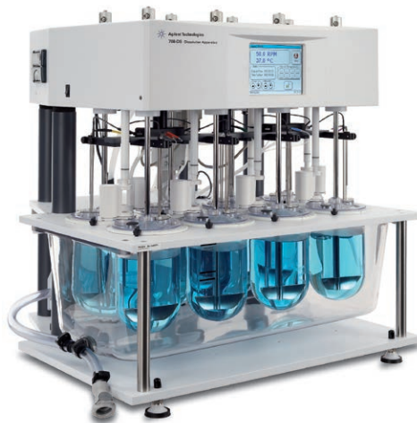
图 2 708-DS 溶出度仪的设计提供了高重现性以及更为简便的认证，是标准化溶出度测试的理想平台
