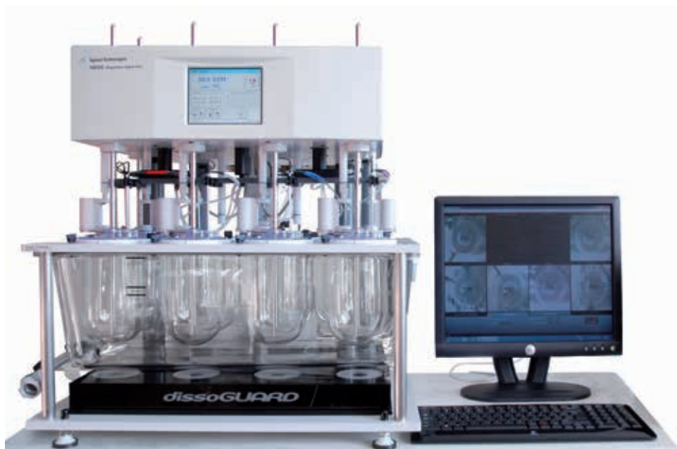
Рис. 2. Система наблюдения dissoGUARD, объединенная с прибором для испытания растворимости Agilent 708-DS
