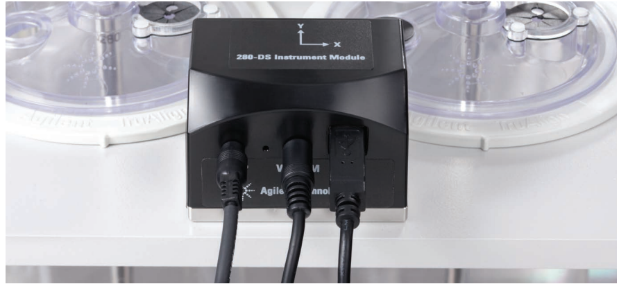
使用 280-DS IM 和溶出度工作站软件监测溶出度测试过程中的振动情况
