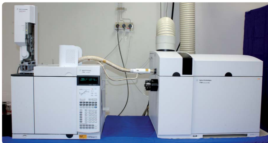
图 1. 和安捷伦 7700 系列 ICP-MS 连接的新型 GC-ICP-MS 接口套件 (G3158C)
