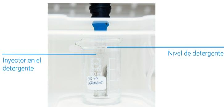
Figura 2. Asegúrese de que el inyector y el tubo exterior están sumergidos y en remojo en la solución detergente.
