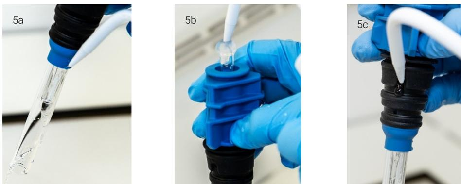
Figuras 5a, 5b y 5c. Lave la antorcha con agua desionizada y lave el inyector y los puertos de gas.
