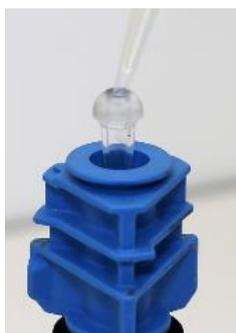
**Figura 4.** Pipetee parte de la solución de ácido a través del extremo abierto de la rótula para lavar el inyector.
