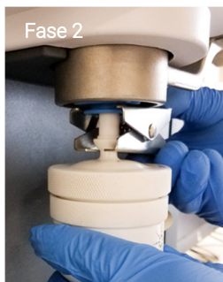
Figura 4. Installazione della camera di nebulizzazione inerte sulla torcia inerte MP-AES.
