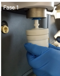
Figura 4. Installazione della camera di nebulizzazione inerte sulla torcia inerte MP-AES.
