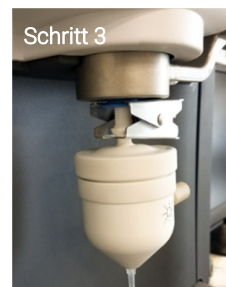
Abbildung 4. Verbinden der inerten Zerstäuberammer mit der inerten Fackel des MP-AES.
