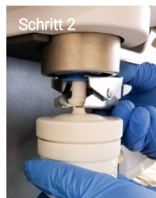
Abbildung 4. Verbinden der inerten Zerstäuberammer mit der inerten Fackel des MP-AES.
