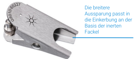
Abbildung 3b: Empfohlene Klemme für die inerte MP-AES-Fackel
