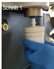
Abbildung 4. Verbinden der inerten Zerstäuberammer mit der inerten Fackel des MP-AES.
