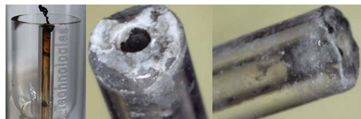
동일한 용도에 알루미나 인젝터를 사용하는 경우에도 인젝터에 탄소가 쌓이는 현상이 발생합니다(아래 그림 참조). 블로우 토치를 사용하여 탄소를 태운 후, 인젝터 팁에 일부 무기 잔류물이 남습니다(가운데). 회석된 산에 담가두면 이 잔류물이 쉽게 제거되어 인젝터가 깨끗해집니다(오른쪽). 사진에 나온 알루미나 인젝터는 5회의 세척 주기를 마친 상태로, 석영 인젝터에서 동일한 횟수로 세척했을 때보다 성능 저하가 없고 분석 실행 시간에 아무런 영향이 없습니다.
