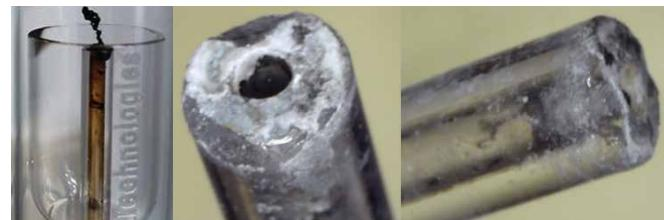
同じアプリケーションでアルミニウムインジェクタを使用した場合も、インジェクタの炭素蓄積は発生します（下の写真）。プロートーチを使用して炭素を燃焼させた後に、インジェクタの先端に一部の無機残留物が残ります（中央）。これは、希酸に浸することで簡単に除去でき、インジェクタがきれいになります（右）。写真のアルミニウムインジェクタには、石英インジェクタと同じように 5 回の洗浄サイクルを実行しました。劣化は生じず、性能や分析時間に影響はありませんでした。
