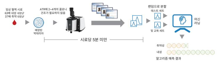
Agilent Cary 630 FTIR 분광기를 이용하여 이 간단한 워크플로에 따라 약물 내성을 나타내는 변종에 대해 박테리아 시료를 분석했습니다. 박테리아 시료는 건조할 필요 없이 ATR에 직접 배치되었습니다. 시료와 스펙트럼 수집 시간이 시료당 5분 미만으로, 최신 절대 표준을 이용한 게놈 시퀀싱에 필요한 시간보다 현저히 짧습니다.
